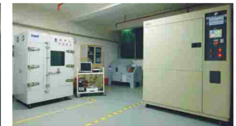
Камера испытаний на естественную конвекцию (слева) Камера испытаний на стойкость к тепловому удару (справа)
